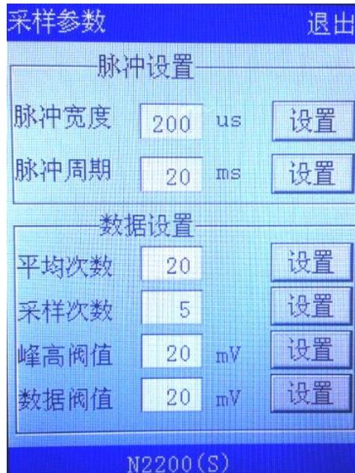
图 5.6 采样参数设置界面
